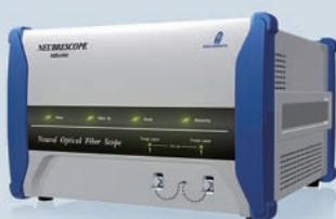
ニューブレクス㈱ではパルス・プリポンプ（特許出願済）の技術を用いて、従来のBOTDR技術の限界であった空間分解能及び精度を飛躍的に向上させることに成功しました。PPP-BOTDA（Pulse-PrePump Brillouin Optical Time Domain Analysis）では空間分解能10cm、ひずみ測定精度 $\pm 25 \mu \epsilon$ 、再現性 $\pm 15 \mu \epsilon$ を世界で初めて実用化し、NBX-6000として販売しています。
